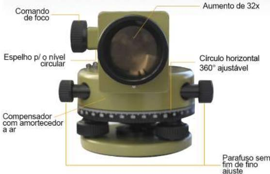
Equipado com o botão de verificação do funcionamento do compensador.
